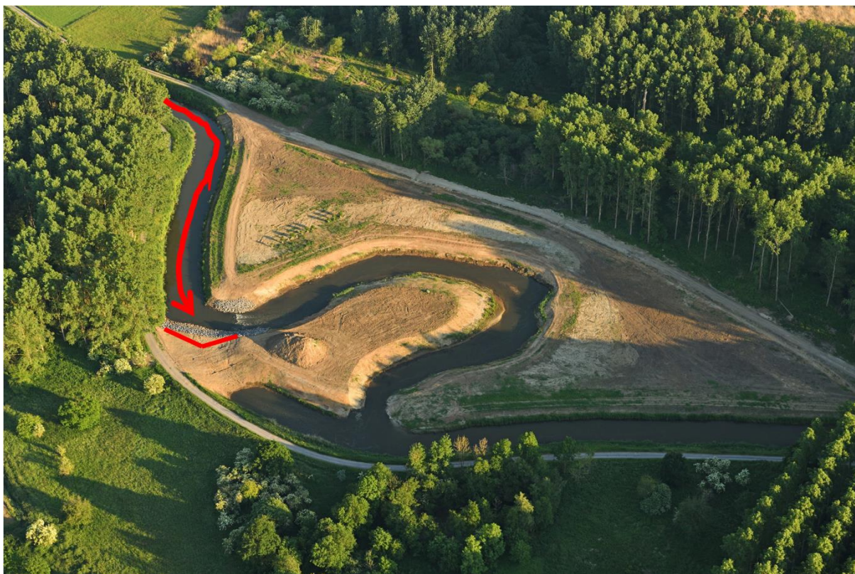
Figuur 13 Voorbeeld van nieuwe meander op de Demer (Scherpenheuvel-Zichem) met V-vormige bypass, die in geval van hoge piekafvoeren ook water naar de oorspronkelijke Demer afvoert
