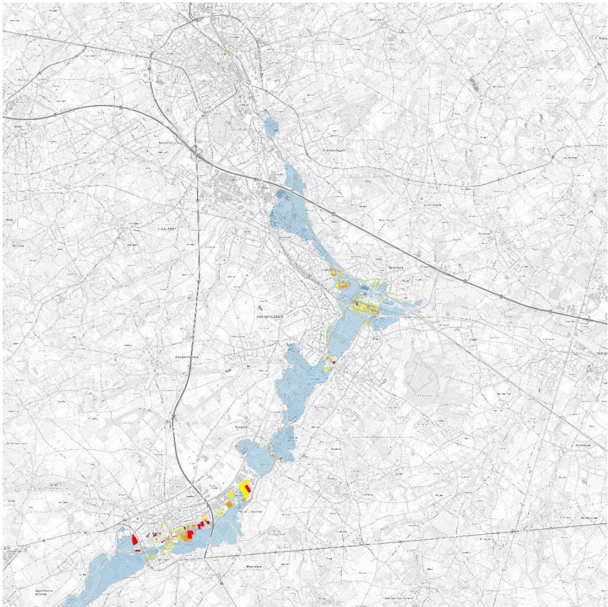
Figuur 3 Schematische voorstelling van het effect van een alternatief op de overstromingsdiepte in de vallei bij een piekafvoer T100 ten opzichte van de referentietoestand
